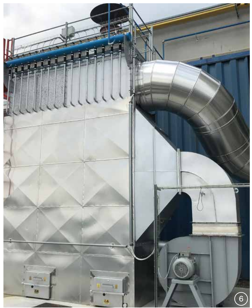
Scambiatore di calore autopulente / Auto self cleaning heat exchanger
