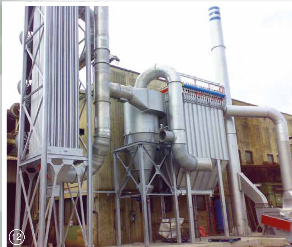
Filtro fumi e scambiatore di calore per forno da fonderia di ghisa Fumes filter and heat exchanger for cast iron kiln
